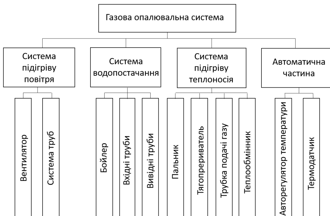
Рис. 4. Структурна схема газової опалювальної системи
